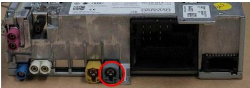
Drücken Sie den grauen oder rosa Videostecker in die Palette am Boden. Heben Sie sehr sorgfältig mit einem kleinen flachen Objekt zwischen der Naht, wenn der Stecker sehr eng ist. Lassen Sie den Rest der Stecker eingesteckt. Schneiden Sie bei Bedarf ein Band zwischen die Kabel, so dass genügend Bewegungsfreiheit vorhanden ist, um das dicke Kabel und das Videokabel aus dem Gehäuse zu ziehen.
